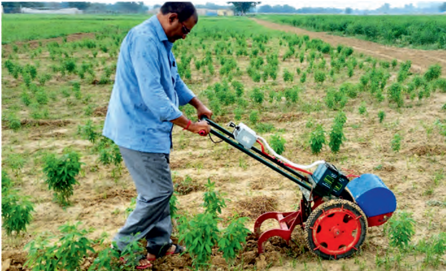
तीन टाइन वाले कल्टीवेटर के साथ पूसा मिनी इलेक्ट्रिक एग्री प्राइम मूवर
